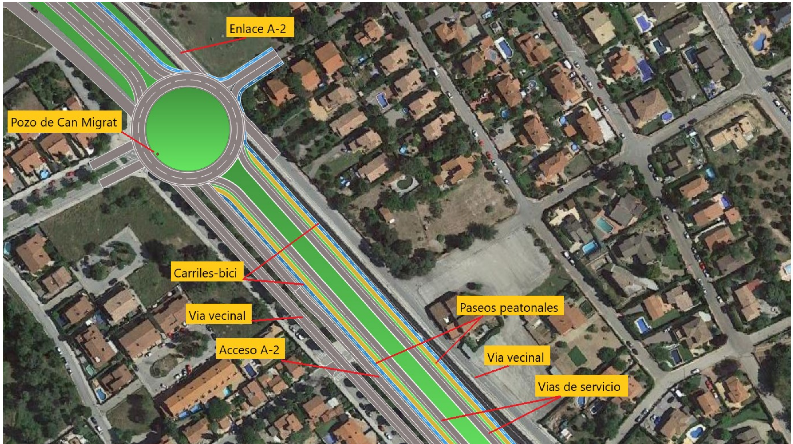
Plano número 7. Rotonda accesos al núcleo urbano y acceso Autovía A-2 sobre la cubierta del falso túnel (propuesta Ayuntamiento)
